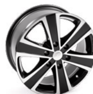
GSM16 Black Polished Glossy Felgengröße: 8,0 x 18 Zoll Tragfähigkeit: 1.125 kg Einpresstiefe: 30 mm Lochkreis: 6 x 139 mm Fahrzeug: Isuzu D-Max
