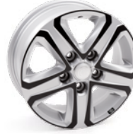
GSM6 Silver Black Glossy Felgengröße: 6,5 x 16 Zoll Tragfähigkeit: 1.450 kg Einpresstiefe: 52 mm Lochkreis: 5 x 130 mm Fahrzeug: Fiat Ducato
