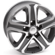
GSM6 Anthracite Polished Glossy Felgengröße: 6,5 x 16 Zoll Tragfähigkeit: 1.450 kg Einpresstiefe: 52 mm Lochkreis: 5 x 130 mm Fahrzeug: Fiat Ducato
