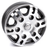
GSM2 Anthracite Polished Glossy Felgengröße: 6,0 x 16 Zoll Tragfähigkeit: 1.150 kg / 1.400 kg Einpresstiefe: 50 mm / 78 mm Lochkreis: 6 x 170 mm / 6 x 205 mm Fahrzeug: Iveco Daily
