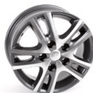
GSM8 Anthracite Polished Glossy Felgengröße: 6,0 x 16 Zoll Tragfähigkeit: 1.200 kg / 1.350 kg Einpresstiefe: 68 mm Lochkreis: 5 x 118 mm / 5 x 130 mm Fahrzeug: Fiat Ducato
