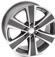
GSH3 Anthracite Polished Glossy Felgengröße: 8,0 x 18 Zoll Tragfähigkeit: 1.215 kg Einpresstiefe: 53 mm Lochkreis: 6 x 130 mm Fahrzeug: Mercedes Sprinter
