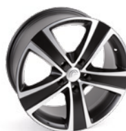
GSH5 Black Polished Matt Felgengröße: 8,0 x 17 Zoll Tragfähigkeit: 1.050 kg Einpresstiefe: 50 mm Lochkreis: 5 x 120 mm Fahrzeug: VW T5 / VW T6 / VW Amarok
